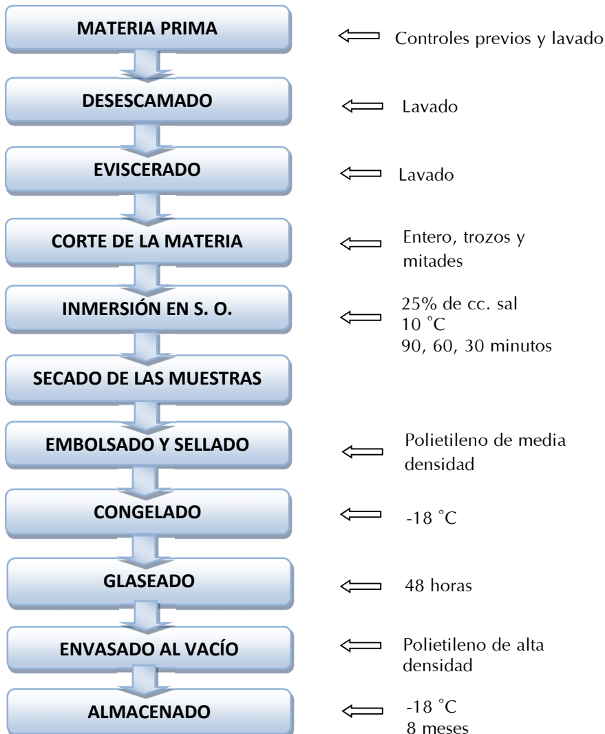
Figura 1. Diagrama de flujo para proceso de conservación del Brycon erythropterus (sábalo) mediante métodos combinados.
